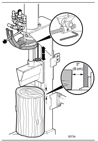
Fig. 8-Stroke Limiter
