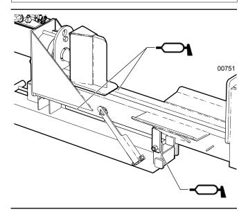
Fig. 18-Splitter Bed Slide
