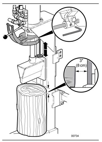
Fig. 8-Stroke Limiter
