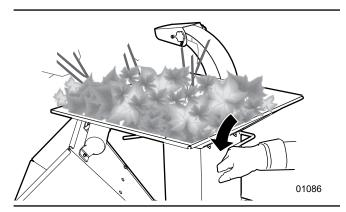
Fig. 28-Shredder Feed Control Handle
