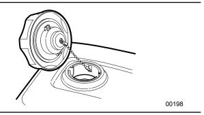
Fig. 17-Fuel Filler Cap
