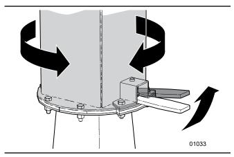
Fig. 15-Discharge Chute Rotation
