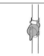
Fig. 13-Fuel Valve Open
