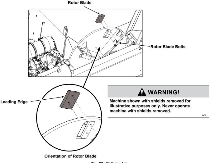
Fig. 26-ROTOR BLADE
