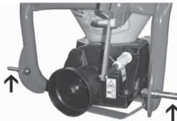
La macchina deve essere posizionata, tramite il sollevamento degli attacchi inferiori della trattrice, in modo che la distanza dalla estremità del tubo distributore al terreno sia di 75 cm (altezza di lavoro).
